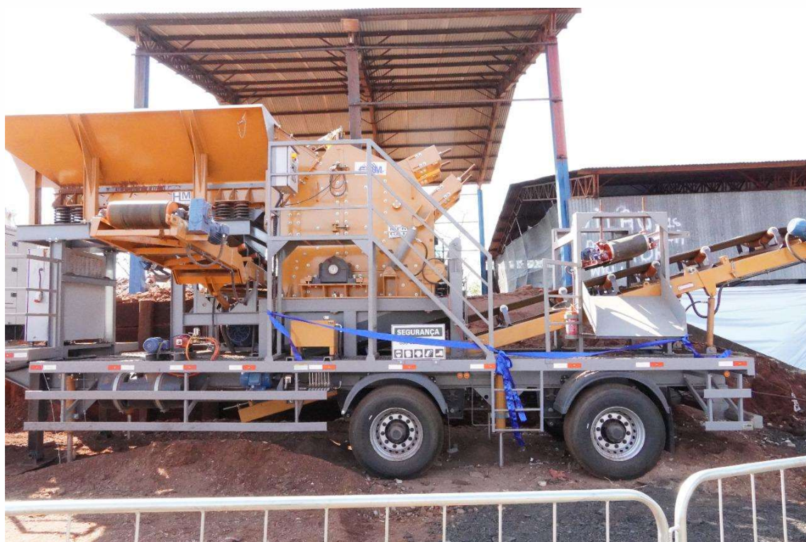
Foto 11: Usina móvel de tratamento de resíduos da construção civil.
